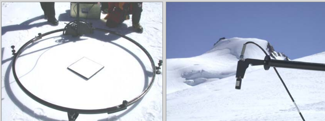
Fig. 7 Goniometro impiegato per le misure angolari con al centro il pannello per la determinazione del "bianco"
