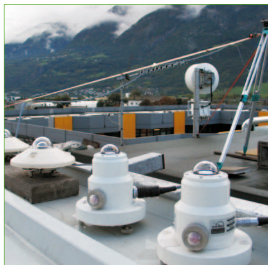
Figura 5 Fotografia scattata durante una intercalibrazione di strumenti a banda larga sulla terrazza della sede ARPA (Saint-Christophe)
