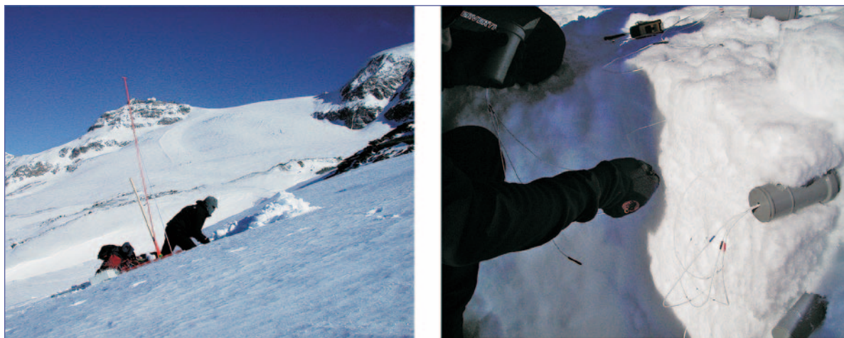
Figura 5 Misure di spessore e densità del manto nevoso e installazione dei sensori di temperatura
