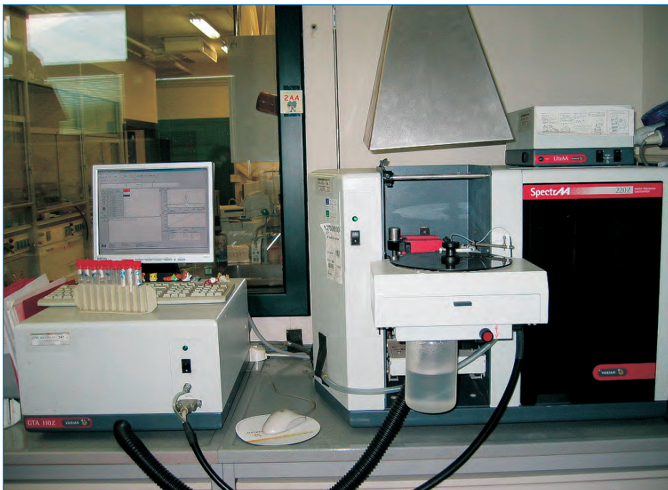
Figura 4 Spettrofotometro a assorbimento atomico Fornetto di Grafite GF-AAS.
