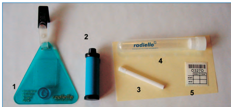
Figura 1 Componenti del campionatore passivo radiello ®
