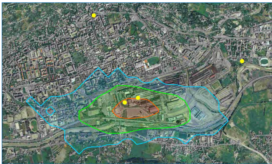
Figura 5 Rappresentazione grafica dei risultati della simulazione modellistica dei livelli di deposizione totale di PM 10 proveniente dalle emissioni diffuse dall'acciaiera nel mese di aprile 2007
