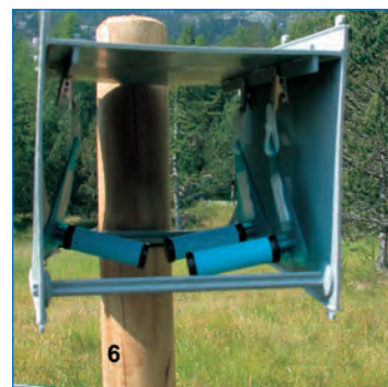
Figura 2 Riparo protettivo per campionatori passivi
