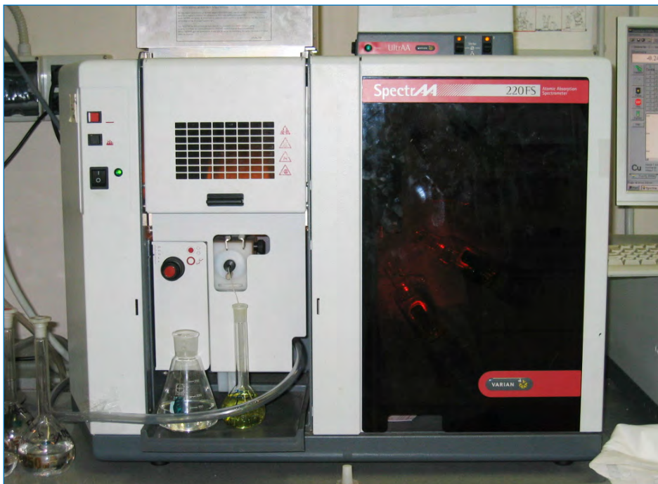
Figura 3 Spettrofotometro di assorbimento atomico Fiamma F-AAS.
