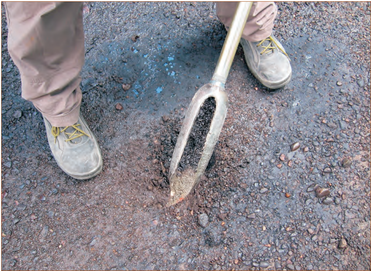
Figura 3 Prelievo di suolo superficiale. A seguito di uno sversamento di gasolio sono palesemente contaminati i primi 25 cm di terreno.
