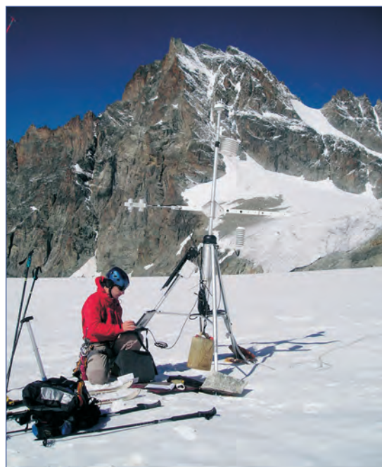
Figura 4 Stazione meteorologica automatica removibile installata sul ghiacciaio di Tsa de Tsan
