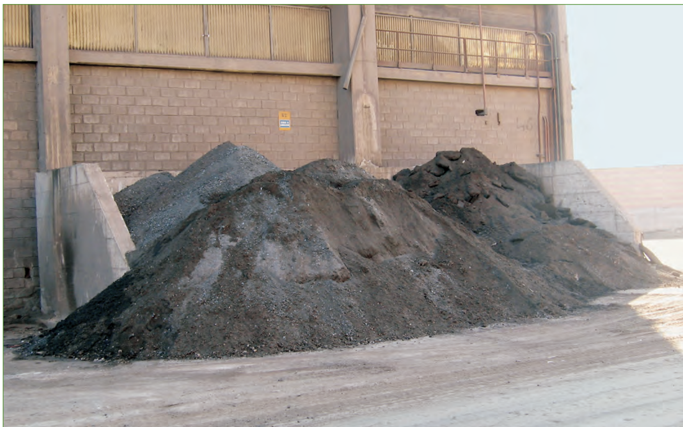
Deposito scaglie di laminazione della Cogne Acciai Speciali S.p.A.
