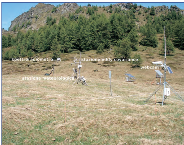
Figura 3 Strumentazione utilizzata per il monitoraggio dei flussi di CO 2 in pascolo
