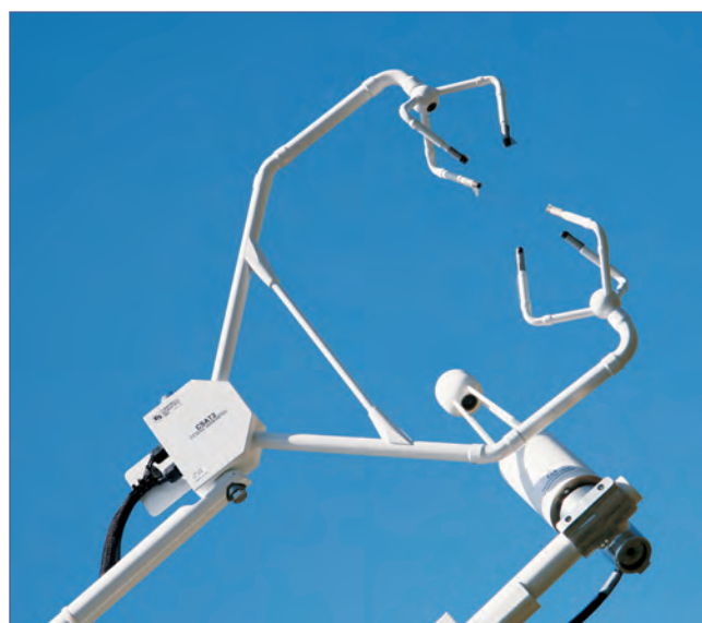
Figura 4 Strumentazione eddy covariance costituita da un anemometro sonico tridimensionale e un analizzatore di CO 2 a infrarossi a cammino aperto
