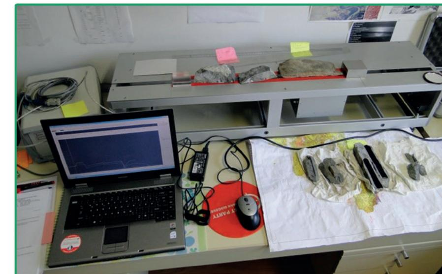
**Fig. 20:** Dispositivo per la determinazione della conducibilità termica. Due campioni di roccia sono posti sulla linea di scansione a infrarossi tra due standard di riferimento.
