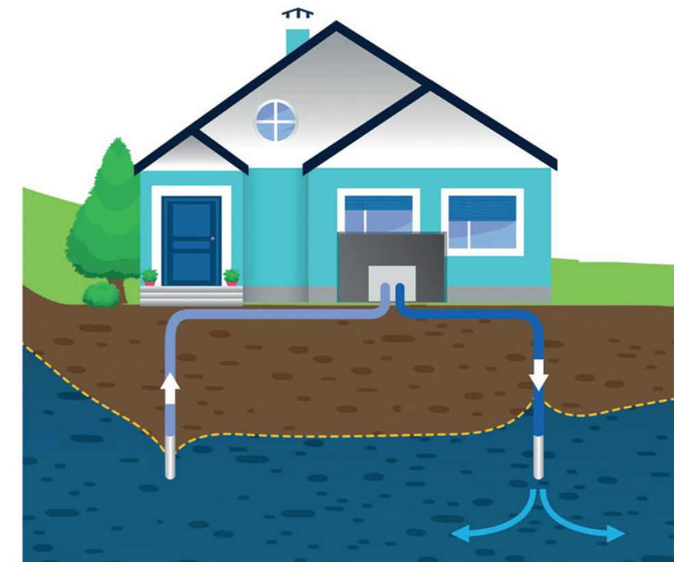
**Fig. 9:** Sistema geotermico a circuito aperto: pompa di calore, pozzo di presa e pozzo di resa. Fonte: BRGM
