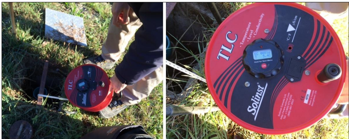
Figura 4.58 – Sonda multiparametrica in grado di misurare soggiacenza temperatura e conducibilità dell'acqua di falda (foto Borinatto).
