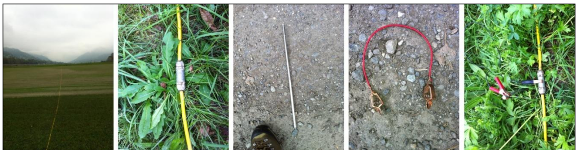
Figura 4.12 – Elementi necessari per la realizzazione dello stendimento geoelettrico, da sinistra verso destra si può osservare: lo stendimento dei cavi multipolari, i connettori, i picchetti metallici, le fascette in rame e l'accoppiamento dei tre elementi precedenti (foto Borinatto).
