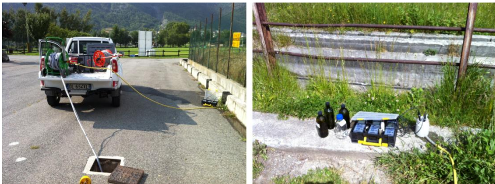
Figura 3.2 – Prelievo di campioni di acqua di falda rappresentativi delle condizioni dell'acquifero per determinare l'indicatore qualitativo. A destra: misura in sito dei parametri di campo (pH, temperatura, conducibilità elettrica e ossigeno disciolto) (foto Borinatto).
