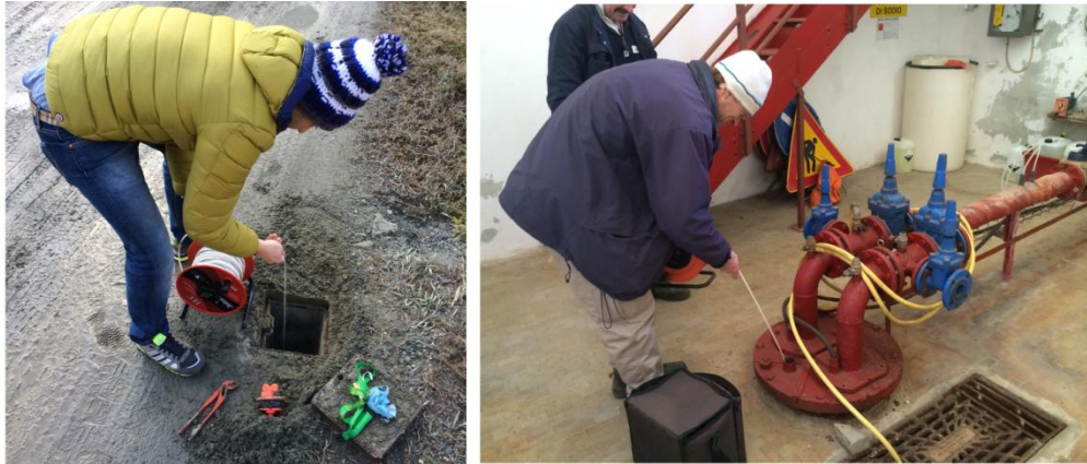
Figura 3.1 – Misura manuale della soggiacenza tramite sondino piezometrico: a sinistra, in un piezometro; a destra, in un pozzo.
