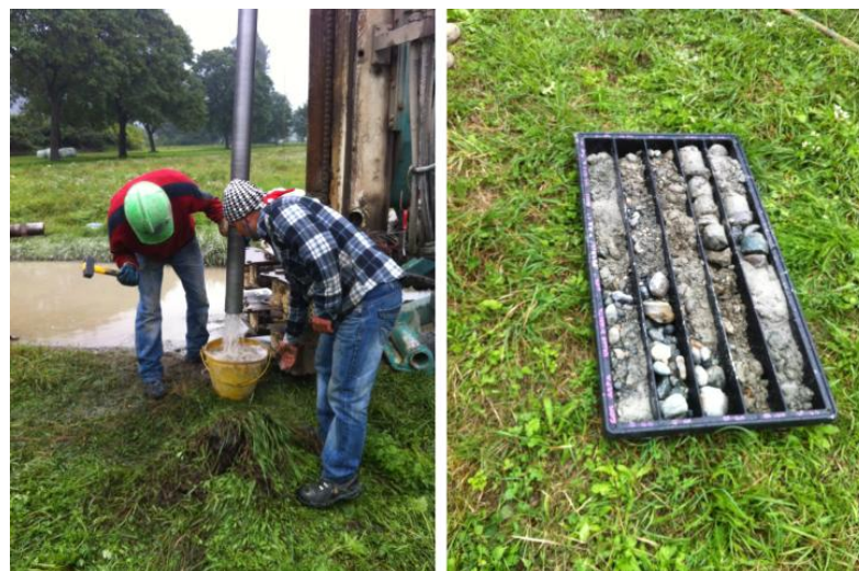
Figura 4.6 – A sinistra: estrazione della carota; a destra: materiale all’interno della cassetta porta campione (foto Borinatto).
