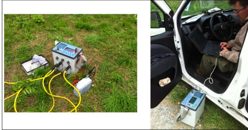
Figura 4.13 – A sinistra georesistivimetro (Syscal PRO 72-96 canali) collegato ai cavi multipolari e alla batteria; a destra scaricamento dei dati acquisiti sul personal computer (foto Borinatto).
