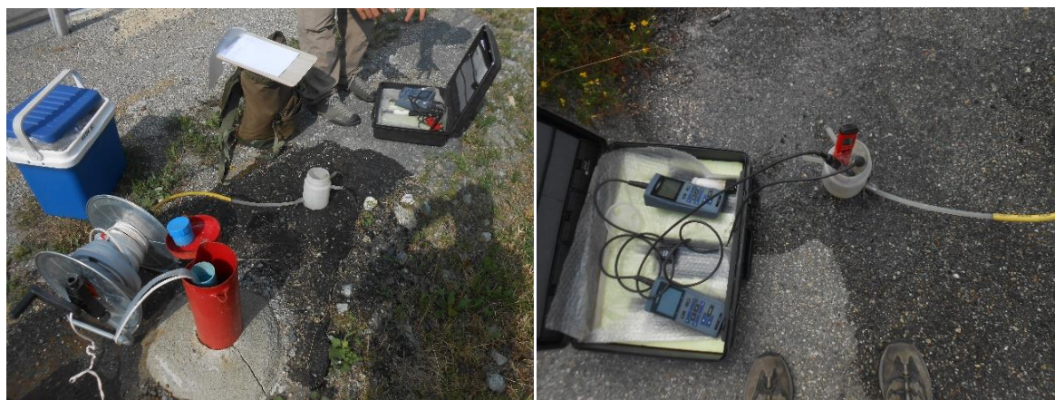
Figura 3.11 – Operazioni di campionamento delle acque sotterranee (Foto Francesco Ghia).
