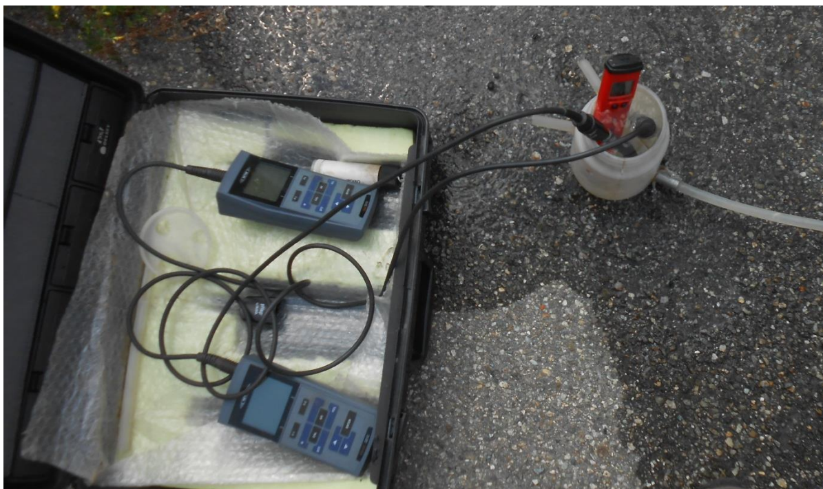
Figura 4.11 – Fase di spurgo fino a stabilizzazione di parametri chimico-fisici dell'acqua (temperatura, pH, conducibilità e O 2 ).
