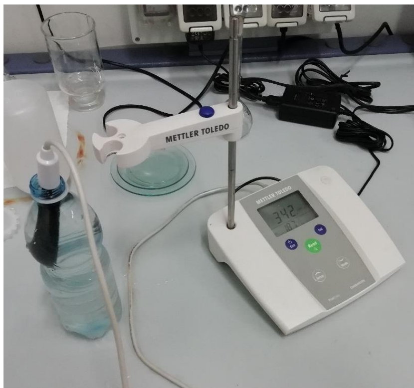
Figura 4.3 – Misura della conducibilità di uno dei campioni
