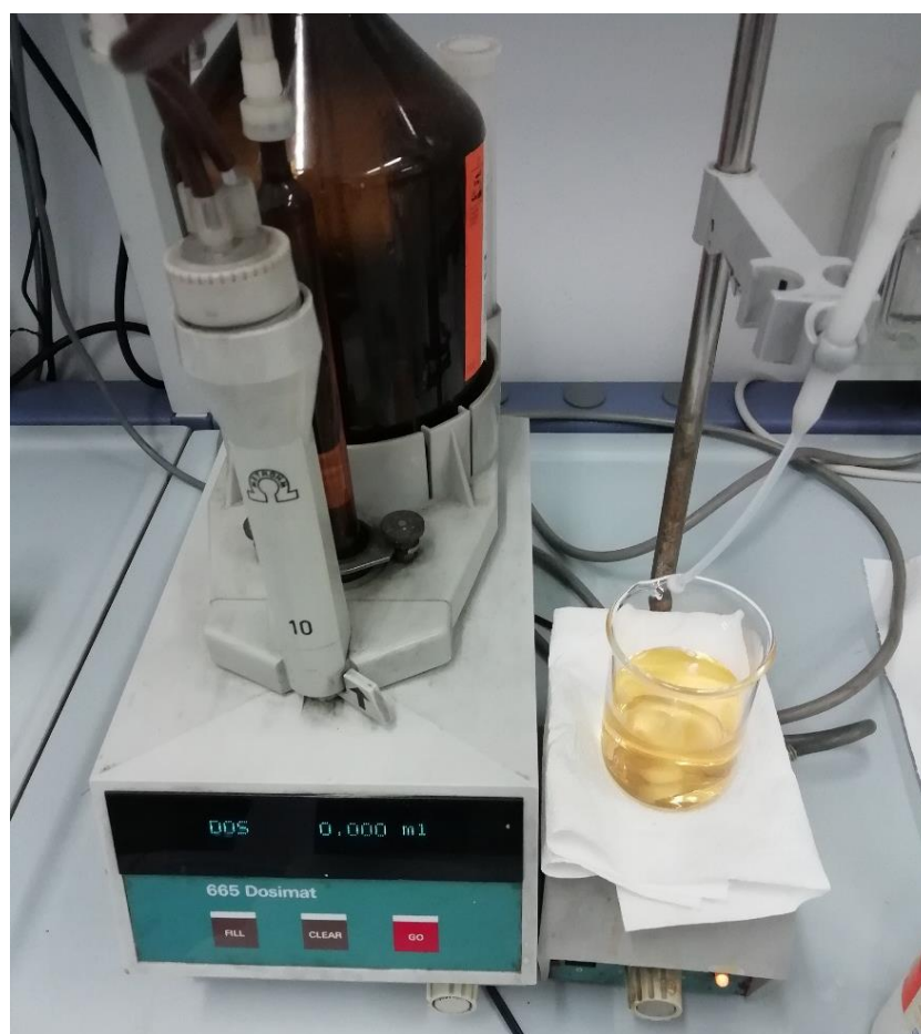
Figura 4.4 – Titolatore automatico con campione addizionato di metilarancio.
