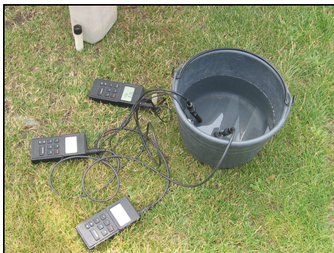
Figura 4.89 - Sonde portatili per la misura dei parametri chimico-fisici.
