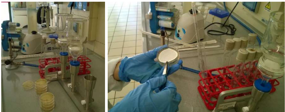
Figura 4.4 - Filtrazione del volume minimo di 10 mL in bicchieri sterili e inoculo della membrana di nitrocellulosa su piastre di C-EC
