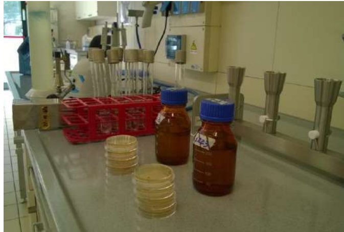
Figura 4.3 - Campioni prelevati in bottiglie Durex da 200 mL, piastre di C-EC, provette di diluente e rampa di filtrazione
