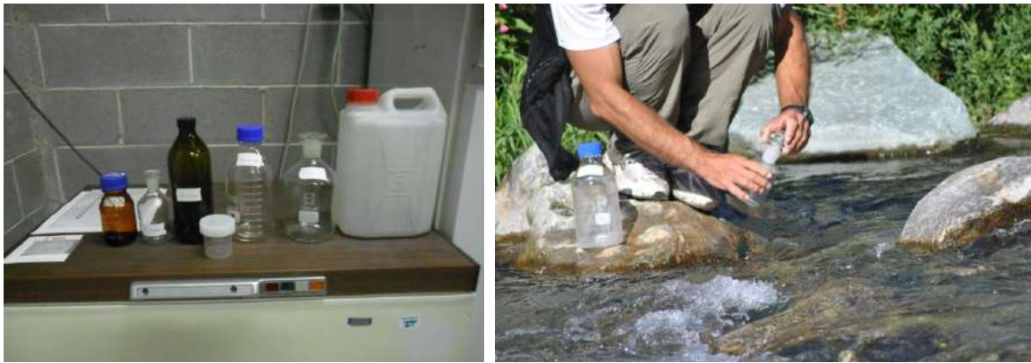
Figura 4.2 – Vetreria necessaria e prelievo di acque superficiali per la ricerca di diversi parametri
