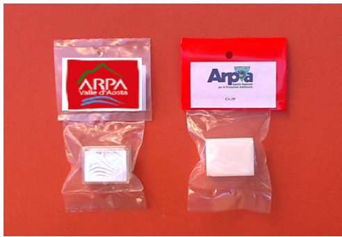
Fig. 3 – Dosimetri passivi a tracce con rivelatori LR115 (a sinistra) e CR39 (a destra)
