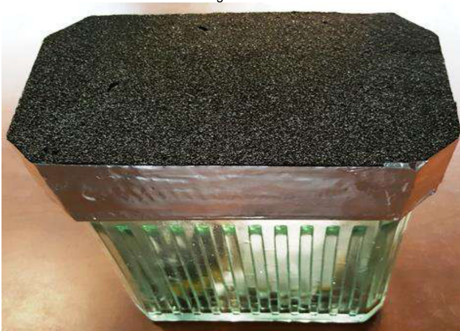
Allestimenti sperimentali per la valutazione della permeabilità del vetro cellulare
