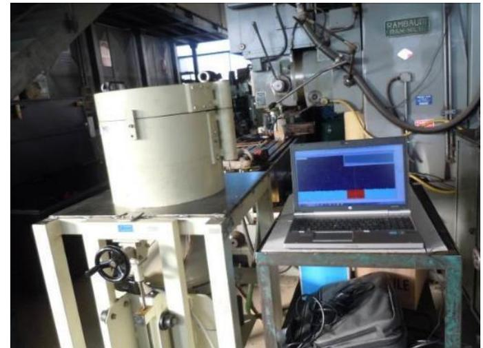
*Acquisizione di uno spettro di fondo in carpenteria dopo l'asportazione di 1 mm di superficie interna.*
