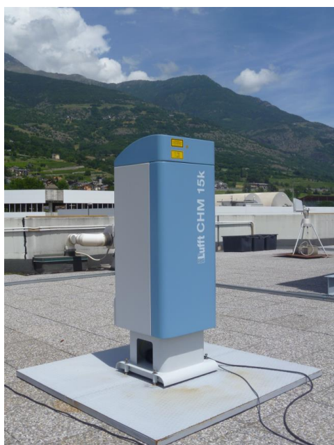
Fig. 1: Tra gli strumenti di misura di ARPA Valle d'Aosta più utili a "sondare" la struttura verticale dell'atmosfera, vi è il LiDAR-ceilometer: un raggio laser a impulsi viene emesso al livello del suolo e il suo "eco", originato soprattutto dalla riflessione del raggio su goccioline d'acqua e particolato atmosferico, viene registrato a terra in funzione del tempo trascorso dall'emissione, e dunque della quota raggiunta.
