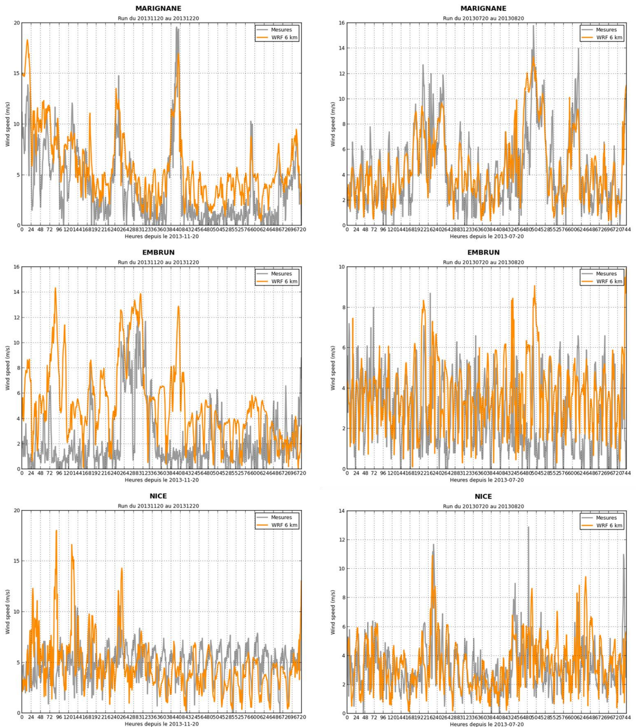
Figure F-4 : Comparaison des intensités de vent horaires à 10m observées (gris) et simulées (orange) au cours de la période hivernale (gauche) et estivale (droite) sur les stations de Marignane (haut), Embrun (milieu) et Nice (bas) / Confronto fra la serie storica simulata (in arancione) ed osservata (in grigio) per la velocità del vento per il periodo invernale (sinistra) e per il periodo estivo (destra) nelle stazioni di Marignane (alto), Embrun (mezzo) e Nizza (basso)
