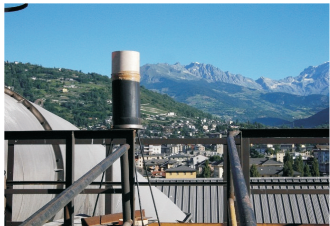
Figura 2: Deposimetro per la caratterizzazione delle emissioni diffuse posto sul tetto dell'acciaiera
