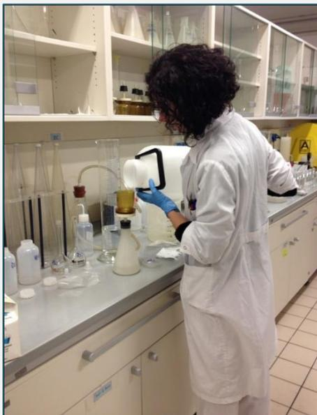
Dopo aver rimosso tutti i corpi estranei (foglie, insetti) si procede con il lavaggio dell'imbuto per trasferire all'interno della bottiglia tutto il materiale adeso alle pareti. In caso di assenza di deposizione umida, si utilizzano i 200 ml di acqua ultrapura del lavaggio e si agita la bottiglia per recuperare tutto il materiale interno. Si procede quindi con la filtrazione dell'intero volume su filtri in esteri misti di cellulosa.
