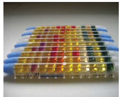
Fig. 5. Kit Enterotube II prima e dopo l'inoculo con colonie isolate su terreno C-EC. A sinistra, i pozzetti sono tutti dello stesso colore, a destra, hanno virato colore in funzione della positività della reazione.
