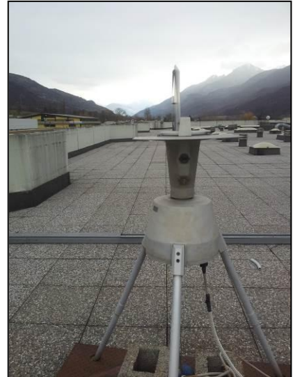
Fig. 5 Campionatore volumetrico (Hirst) posizionato sul tetto dell'ARPA VdA.
