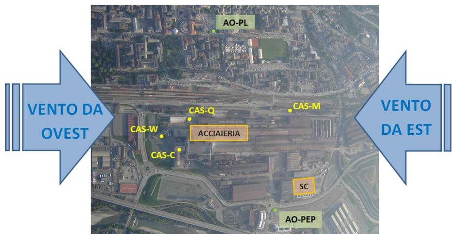
Figura 34 – Le deposizioni di polveri e metalli nei siti CAS-C e CAS-W sono correlate positivamente con la % di ore di vento proveniente da est e negativamente con la % di ore di vento proveniente da ovest
