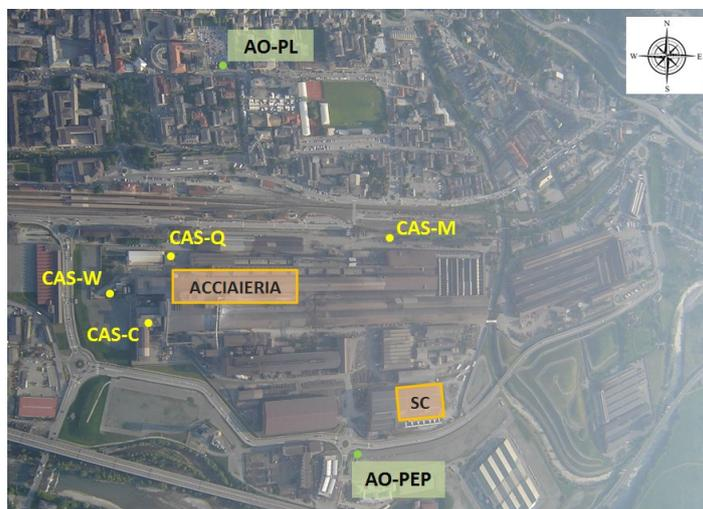
Figura 7 – Siti di misura delle deposizioni atmosferiche all'interno dello stabilimento CAS con indicazione del reparto acciaieria e del reparto trattamento scorie che costituiscono le principali fonti di emissione diffusa di polveri. AO-PEP (Aosta-Pépinière) e AO-PL(Aosta-Plouves) sono siti di misura delle deposizioni atmosferiche del territorio urbano
