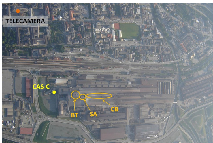
Figura 56 – Localizzazione del punto di misura CAS-C rispetto alle zone di fuoriuscita delle emissioni diffuse (BT, SA, CB)
