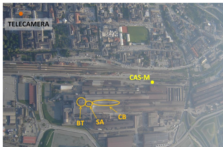
Figura 74 – Localizzazione del punto di misura CAS-M rispetto alle zone di fuoriuscita delle emissioni diffuse (BT, SA, CB)
