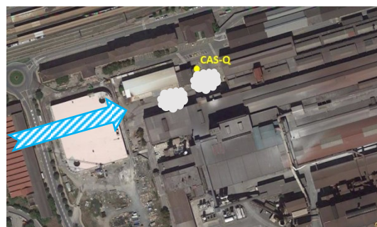
Figura 44 – Localizzazione dei siti di misura rispetto all'acciaieria e particolare della localizzazione del deposimetro CAS-Q. Le “nuvolette” di polvere inserite nell'immagine di destra intendono rappresentare il fenomeno locale di risospensione della polvere ad opera dei venti che soffiano da ovest
