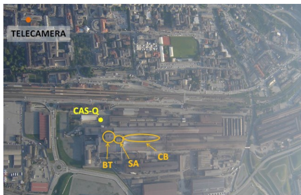
Figura 69 – Localizzazione del punto di misura CAS-Q rispetto alle zone di fuoriuscita delle emissioni diffuse (BT, SA, CB)
