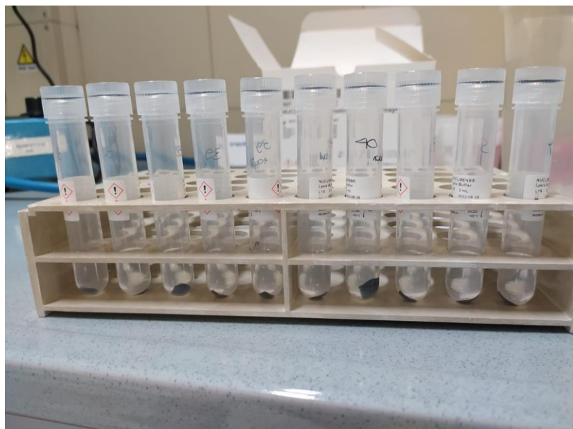
FIGURA 8: le particelle di silice si sono depositate sul fondo delle provette
