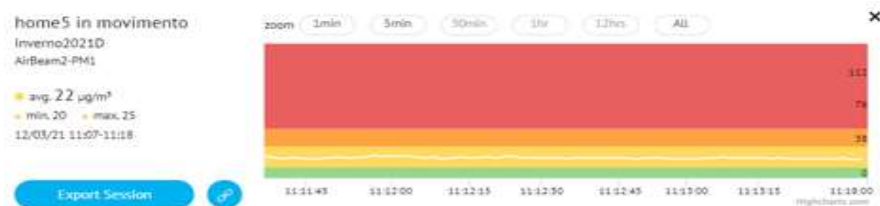
Figura HOME 1 - misura fatta prima della ventilazione con l'apertura delle finestre ma con l'impianto di ventilazione meccanica in funzione.
