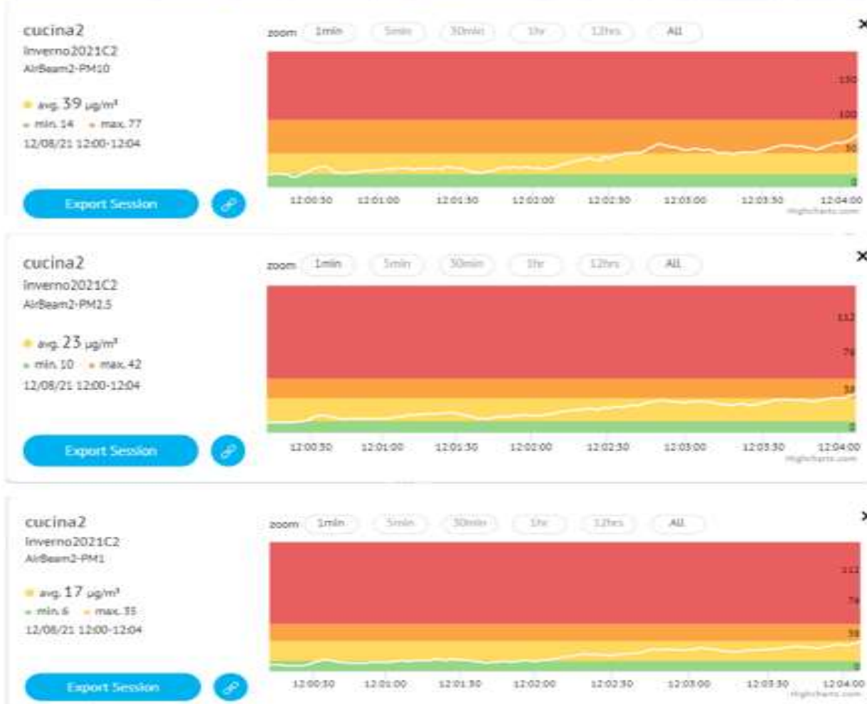
Figura HOME 3 – misura fatta durante la cottura di cibi con finestre chiuse e cappa malfunzionante
