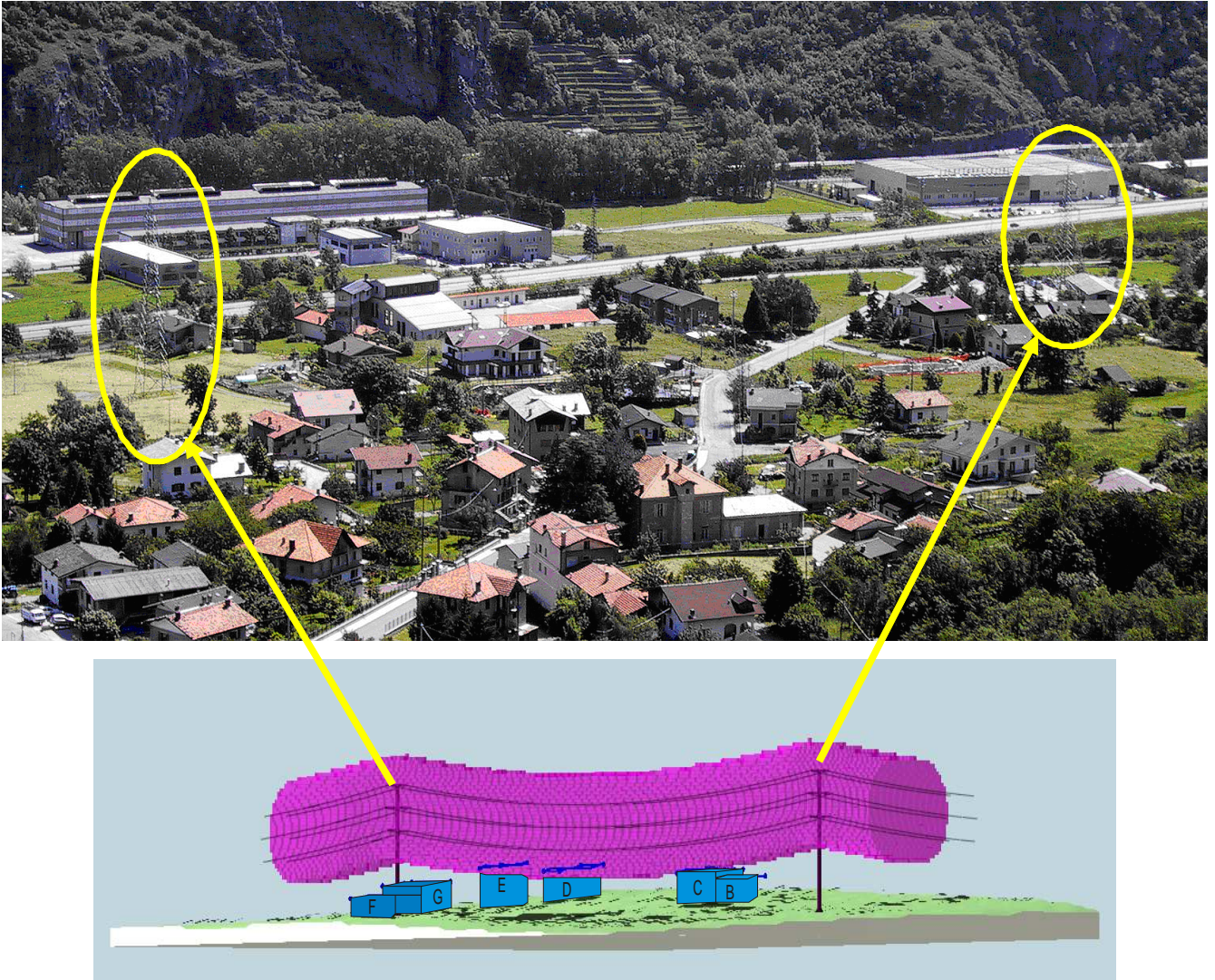
Figura 3. Esempio di simulazione tridimensionale dell'induzione magnetica in prossimità delle abitazioni monitorate.
