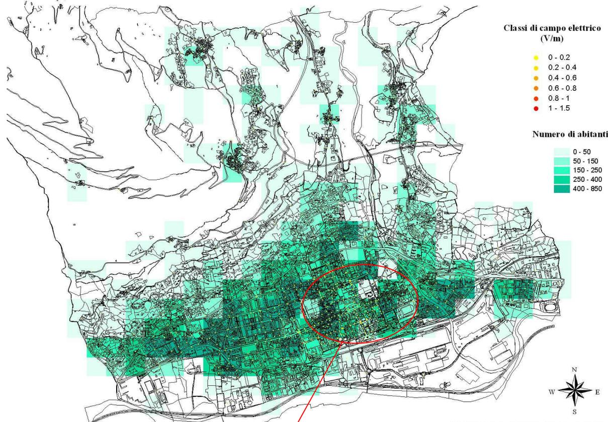
Nella mappa sono indicati la densità di residenti (su una maglia di lato 200 m) e tutti i punti di misura. I punti hanno una colorazione differente a seconda del valore di campo rilevato. Per la zona del centro storico è stata eseguita una interpolazione lineare al fine di mostrare la distribuzione del campo elettrico: tale calcolo non considera l'effetto della presenza delle costruzioni.
