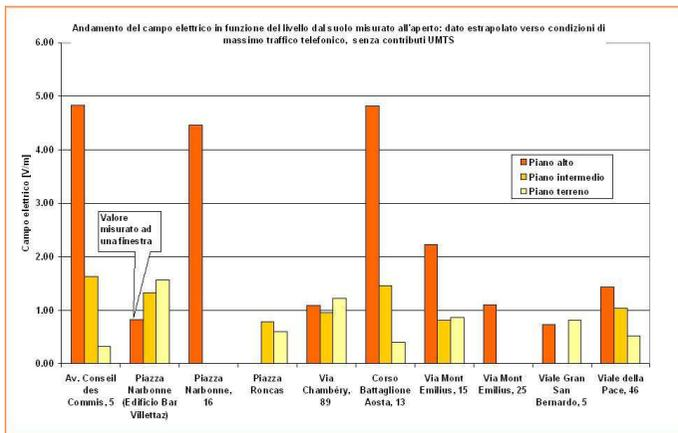
L'analisi dettagliata consente di isolare i contributi al campo elettrico complessivo dovuti alle singole sorgenti: è quindi possibile valutare i contributi dovuti alle trasmissioni radiofoniche (FM) e ai diversi servizi di telefonia mobile e valutare il livello di campo elettrico in condizioni di massimo traffico telefonico.
