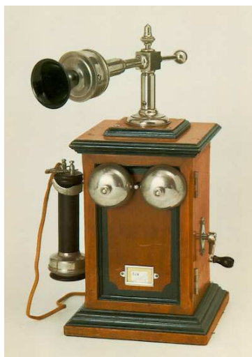
Figura 4.1.2 - telefono con pila e manovella di chiamata
