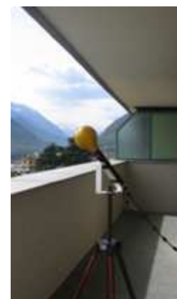
Figura 7.2 - Sonda SRM-3000 durante l'esecuzione delle misure
