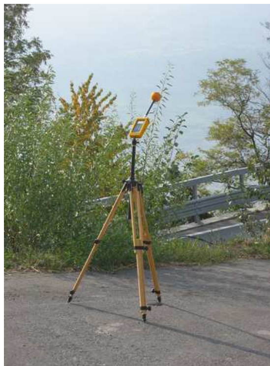
Foto 1 a,b Esempi di rilievo di campo elettrico con metodo a banda larga
