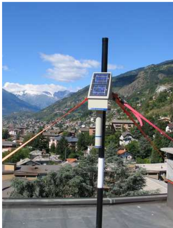
Foto 2 a e b – Esempi di collocazioni di centraline di monitoraggio prolungato del campo E
