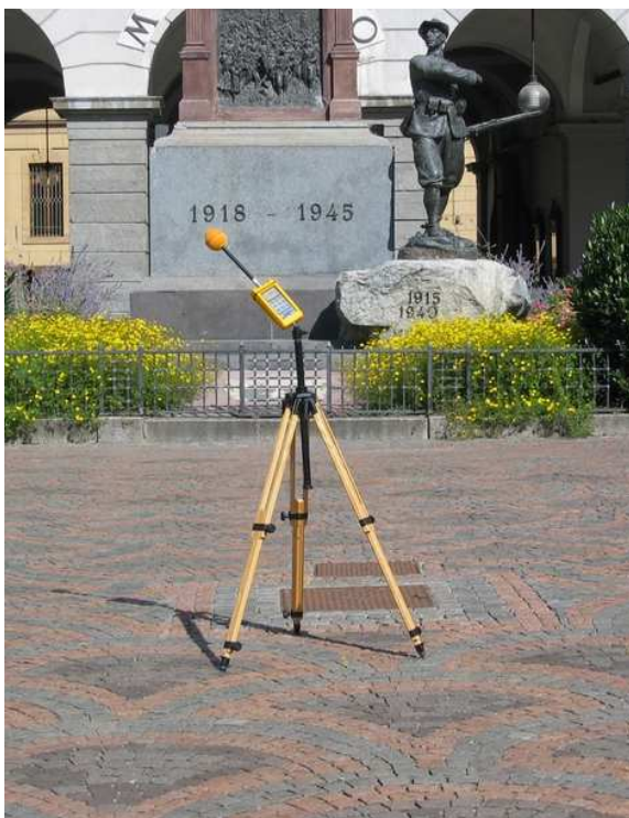
Foto 1 a,b Esempi di rilievo di campo elettrico con metodo a banda larga
