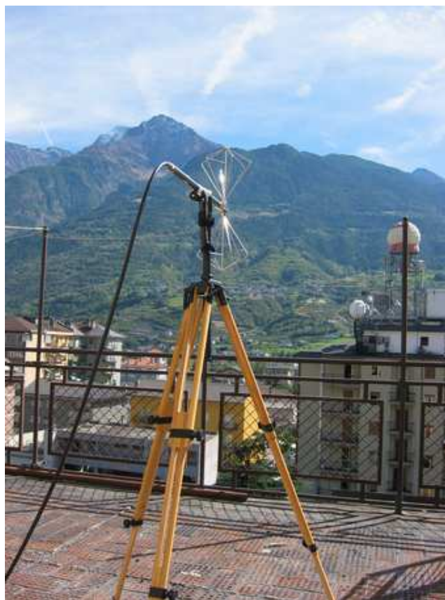
Foto 3 a e b Esempi di misure a banda stretta in un cortile e su un terrazzo
