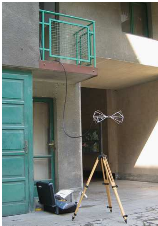
Foto 3 a e b Esempi di misure a banda stretta in un cortile e su un terrazzo
