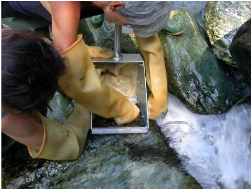
Fig. 4.5 - Campionamento con retino immanicato modificato (Foto ARPA VdA)
