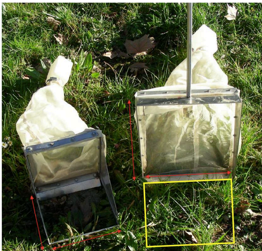
Fig. 4.8 - Rete surber (sinistra) e retino immanicato (destra). Il retino immanicato deve essere utilizzato insieme ad un quadrato (in giallo nella figura) che delimiti l'area di campionamento affinché il campione raccolto possa essere considerato quantitativo (Buffagni & Erba, 2007(a))
