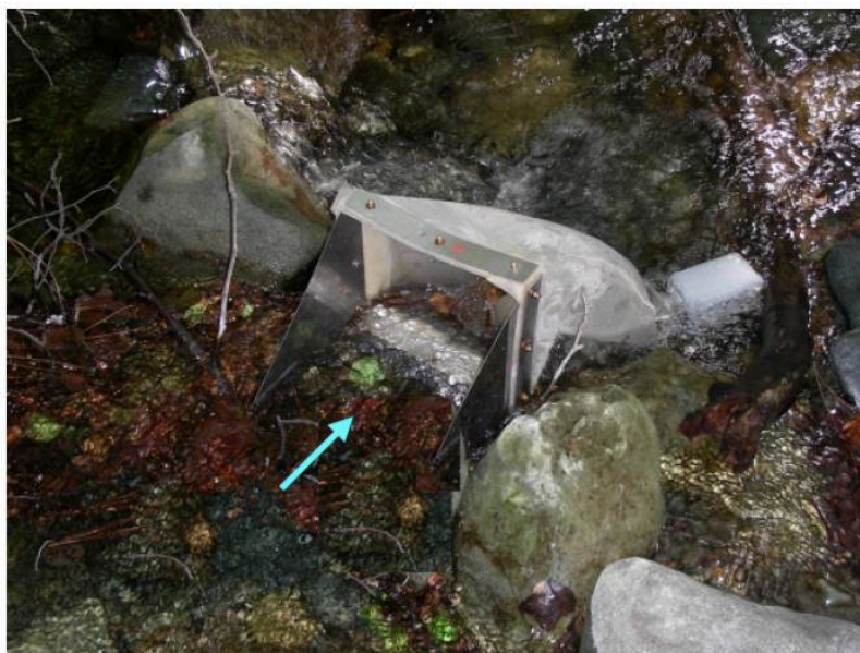
Fig. 4.6 - Posizionamento della rete Surber per il campionamento. La freccia blu indica la direzione del flusso (Erba et al. , 2007)
