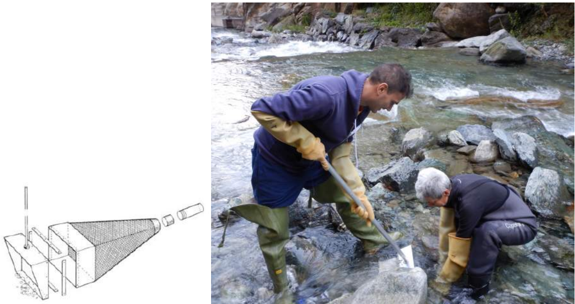
Fig. 4.1 - Retino standard immanicato (a sinistra); raccolta del campione biologico lungo il transetto (a destra) (Foto archivio personale)
