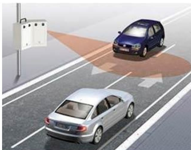
Fig. 2 – Schematizzazione del fascio radar emesso dal contatraffico
