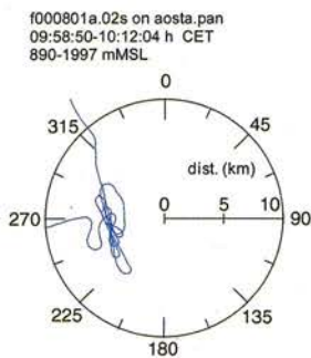
Fig. 3.29 : Représentation panoramique de NOx et d'aérosols selon une coupe transversale près d'Aoste au cours du vol de la matinée du 1 er août. Le sillage du vol projeté sur un plan horizontal est représenté sur la partie supérieure de la figure (coordonnées polaires). L'observateur des panoramas est placé à l'origine de la carte en coordonnées polaires, le regard tourné vers l'ouest (azimut allant de 230 à 290°). La concentration de NOx est distribuée de manière très hétérogène avec des maxima dans la partie nord (partie droite du panorama), près du versant ensoleillé, au-dessus du côté le plus peuplé de la vallée. A cet endroit, le début de la convection est plus intense que sur la pente sud à l'ombre. Les différences sont beaucoup moins prononcées pour les aérosols car ils ne sont pas produits par des émissions près d'Aoste, mais proviennent plutôt de la brume de la vallée entière. La taille des symboles pour la concentration de NOx va de 0.6 à 5 ppb et de 13 à 92 particules/cm 3 pour les aérosols de 0.3 micromètres.
